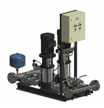
Насосная станция «Soloterm АУПТ» изготовлена на основе вертикальных многоступенчатых насосов, либо на основе консольно-моноблочных насосов, смонтированных на общей раме. Вне зависимости от насосного агрегата, станция «Soloterm АУПТ» комплектуется двумя насосами, подобранными со 100% резервом как по напорной характеристике, так и по расходу перекачиваемой жидкости. В зависимости от модификации «Soloterm АУПТ» может применяться в спринклерных и дренчерных системах водяного и пенного пожаротушения.
